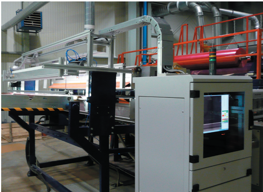
Automatická vizuální kontrola kvality na konci výrobní linky
