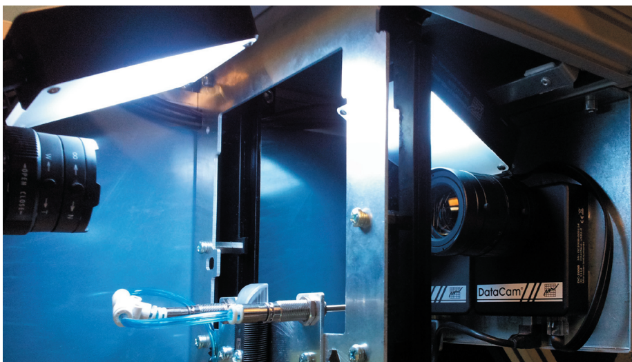
Pohled do nitra snímací hlavy se třemi kamerami a dvěma osvětlovacími jednotkami
